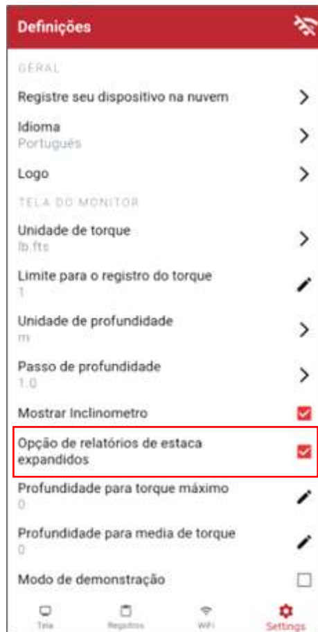
Figura 11. Habilitar opção para relatório detalhado das estacas
