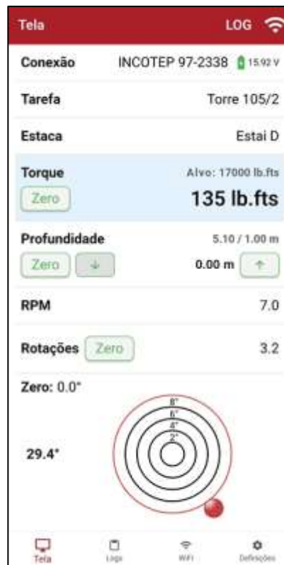
Figura 10. Tela principal para monitoramento da instalação
